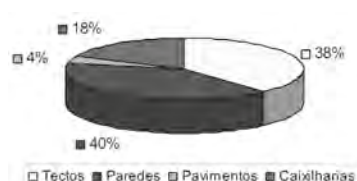
Humidade nas cozinhas e marquises.
