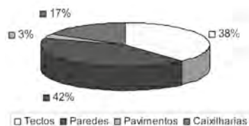
Humidade por elementos de construção.
