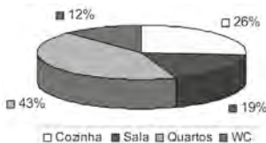
Fissuras por áreas de habitação.
