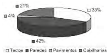
Humidade nas salas.
