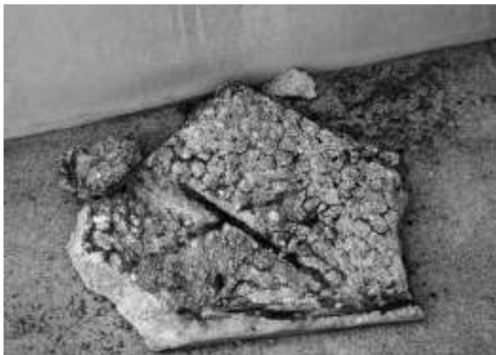
Fig. 57. Fissuração e destacamento de argamassa em estátua por corrosão dos varões metálicos, 2010
