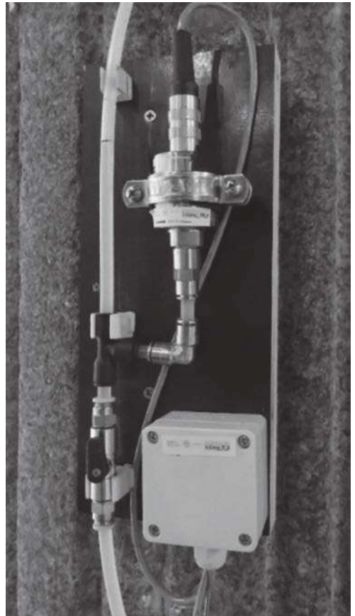
Fig. 28. Igreja dos Congregados - Sensores de nível instalados e em funcionamento no Nível 0, nas Zona 1 e 0: (a) junto à fachada; (b) numa das colunas de suporte do coro-alto;
