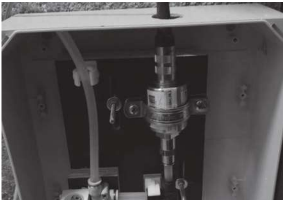
Fig. 15. Medição de assentamentos: (a) Sensor de nível instalado e (b) Esquema de instalação com sensor de referência
